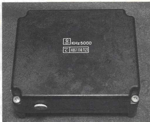
1 - Veduta dell'OCXO Telettra 487.114.021. Notare, in basso a sinistra, il tappo di gomma che copre il foro del contenitore attraverso il quale è possibile accedere al trimmer per la regolazione fine della frequenza di uscita.
